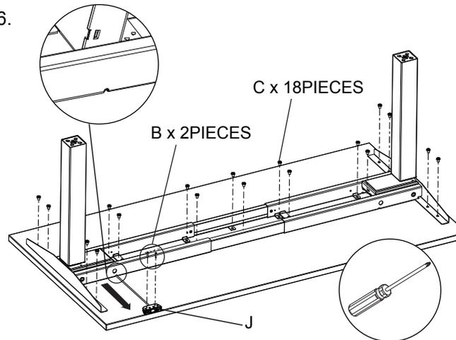
Assurez vous que le câble pour le contrôleur passe à travers la cannelure sous le dessus de la table avant de visser sur le dessus de table
