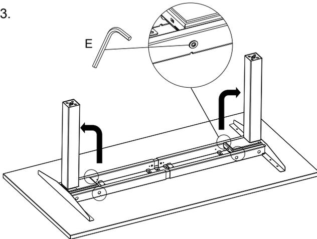
Fije la columna en forma recta, luego apriete los tornillos dentro de la estructura principal
