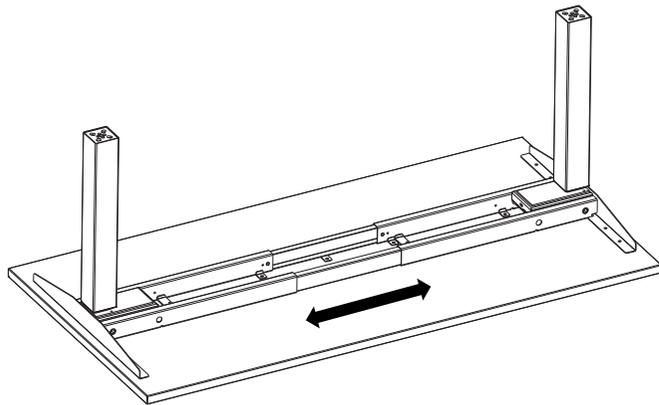
Ajustez la largeur pour adapter au dessus de table
