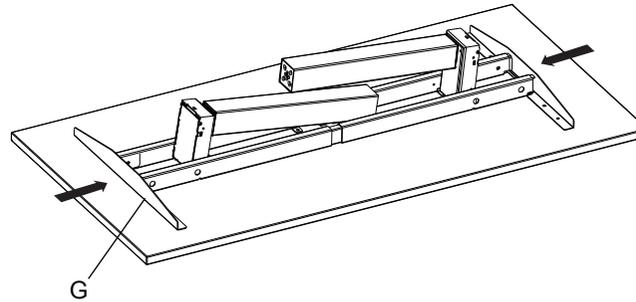
Installez les supports transversaux à la structure principale
