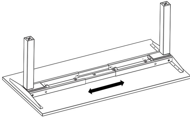
Ajuste el ancho para adaptar la sobremesa
