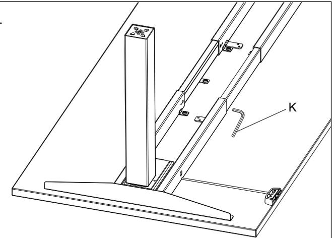
Apriete el tornillo pre-instalado
