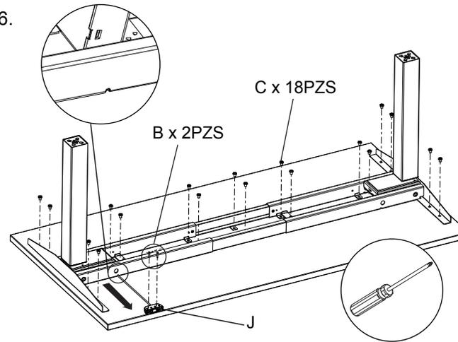
Asegúrese de que el cable para el controlador pase a través de la muesca debajo de la sobremesa antes de atornillar a la sobremesa
