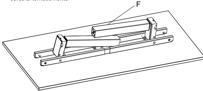
Coloque la estructura principal en la parte trasera de la sobremesa
