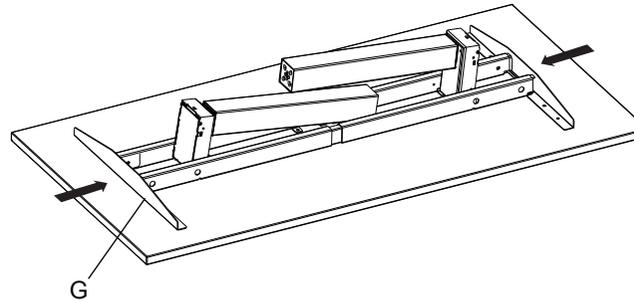
Instale los soportes transversales en la estructura principal
